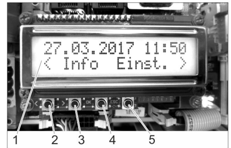
1 Дисплей 2 Кнопка ЛІВОРУЧ (LINKS) 3 Кнопка ПРАВОРУЧ (RECHTS) 4 Кнопка „OK“ 5 Кнопка „ESC“
