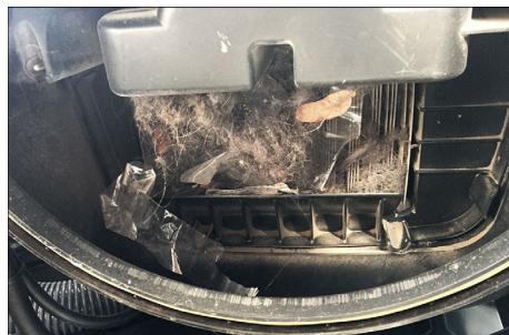
→ Telkens wanneer het vuilreservoir wordt geleegd, moet het vlakke harmonicafilter **van onderen op grove vervuiling** worden gecontroleerd en moet de verontreiniging worden verwijderd.
