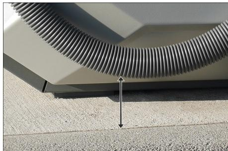
→ Schlauchlänge vor Ort anpassen. Bei eingehängter Autodüse darf Saugschlauch Bediener nicht am Boden aufliegen und muss deshalb zum Boden einen Mindestabstand von 5cm erhalten.
