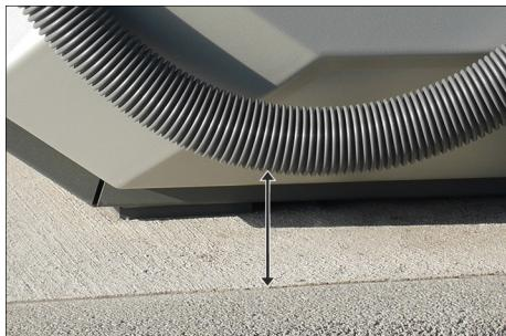
→ Délku hadice upravte na místě. Při zavřené autohubici nesmí sací hadice operátora dosahovat na podlahu a proto musí vzdálenost do podlahy činit minimálně 5 cm.
