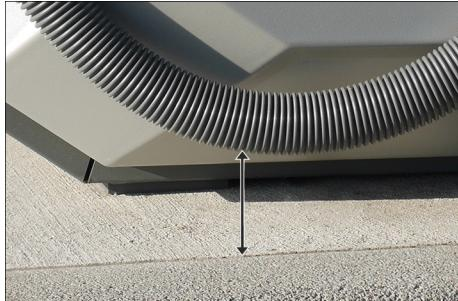
→ Ajustar la longitud de la manguera en la instalación. Con boquilla automática colgada, el control de manguera de aspiración no debe estar en el suelo y debe, de hecho, guardar una distancia mínima al suelo de 5 cm.
