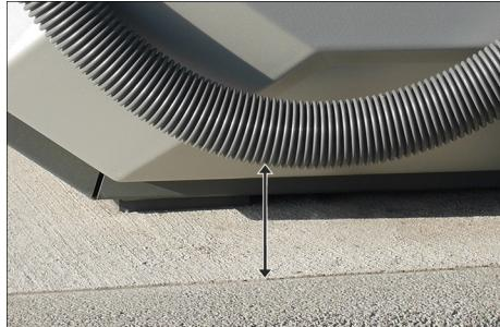
→ Adaptar o comprimento da mangueira no local. Com o bocal auto preso, a mangueira de aspiração do operador não pode assentar no solo devendo, então, manter uma distância mínima em relação ao solo de 5 cm.
