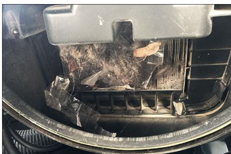
→ Після кожного спорожнення ємності для бруду перевірити дно плоского складчастого фільтра **на наявність великих залишків бруду** та видалити їх у разі виявлення.
