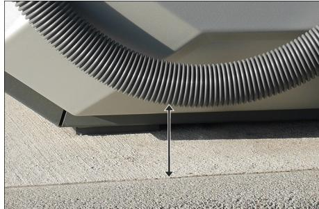
→ A tömlőhosszt a helyszínen igazítsa be. Beakaszott autó belső tisztító fej esetén a szívótömlő-kezelő a szívótömlő nem feküdhet a padlón, ezért a padlótól minimum 5 cm távolságra kell tartani. Szükség esetén a szívótömlő kettős burkolatának hosszúságát át kell állítani.
